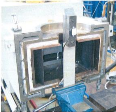
Abbildung 2: Versuchsaufbau Flachproben (Temperaturkammer geöffnet)
