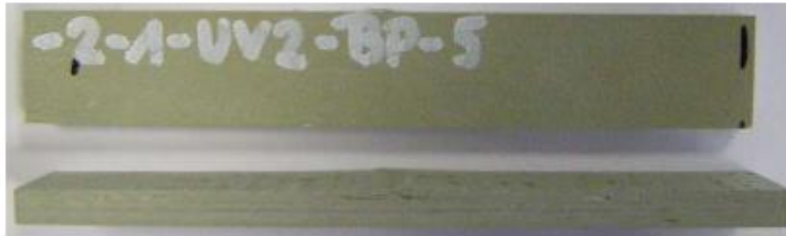
Abbildung 9: Biegeprüfkörper Prüfsérie Gewebe
