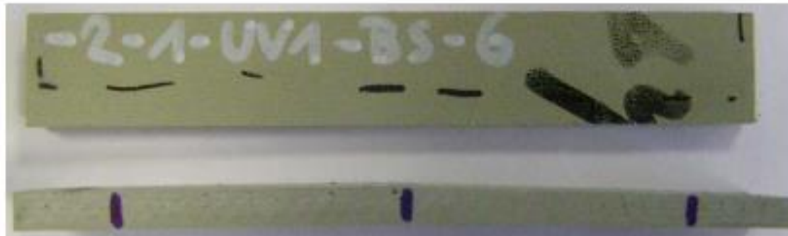
Abbildung 10: Biegeprüfkörper Prüfsérie Gewebe
